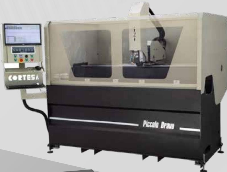
O centro de usinagem “Piccolo Bravo” é projetado para usinagens em perfis metálicos e de PVC, como os utilizados em esquadrias para aberturas e móveis.
